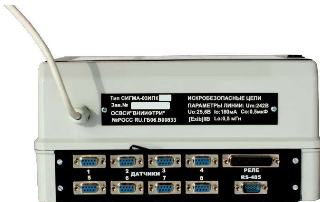
Рис.2.1 Вид задней панели блока информационного СИГМА-03.ИПК 4.4
