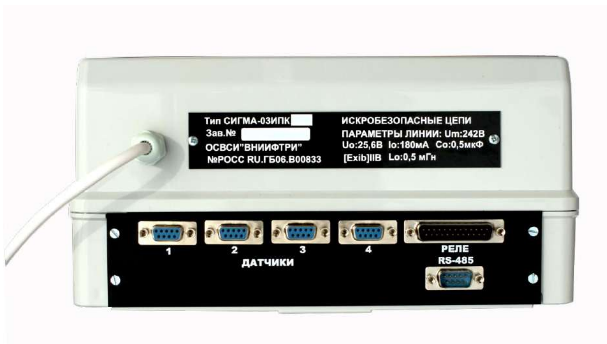
Рис.2.1 Вид задней панели блока информационного СИГМА-03.ИПК 4.4
