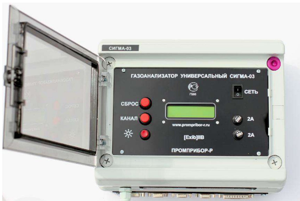
Рис.1. Внешний вид блока информационного СИГМА-03.ИПК
