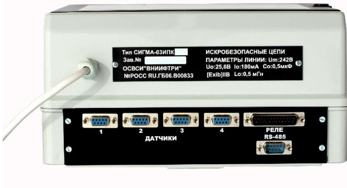
Рис.2 а. Вид задней панели блока информационного СИГМА-03,ИПК4.4 с интерфейсом RS-485
