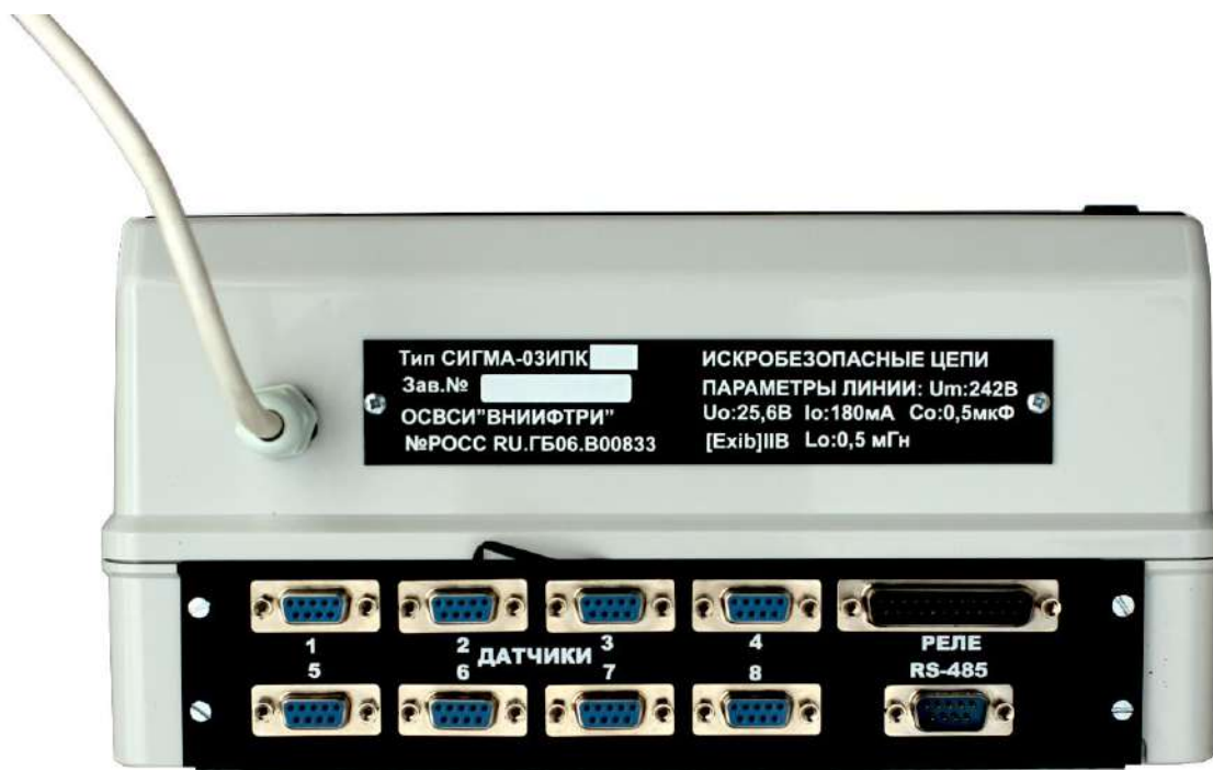
Рис.2 а. Вид задней панели блока информационного СИГМА-03,ИПК4.4 с интерфейсом RS-485
