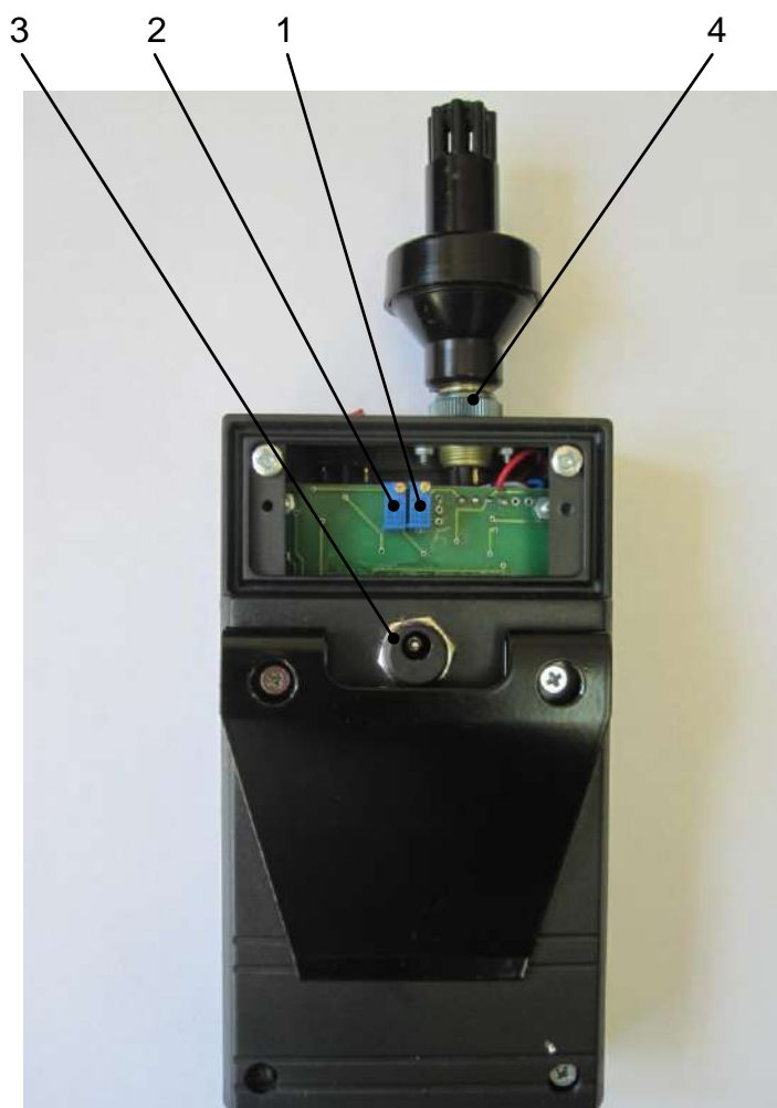
Рис.3. Вид газоанализатора СИГНАЛ-4 сзади со снятой крышкой.
