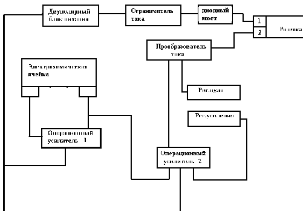
Рис.1. Блок схема датчика СИГМА-03.ДЭ
